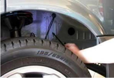
Вибивається вертикально, зчитується з низу, у ніші правого переднього колеса
