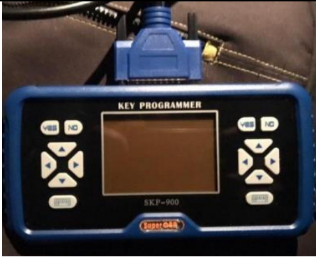
Програматор ключів до замків запалення автомобілів
